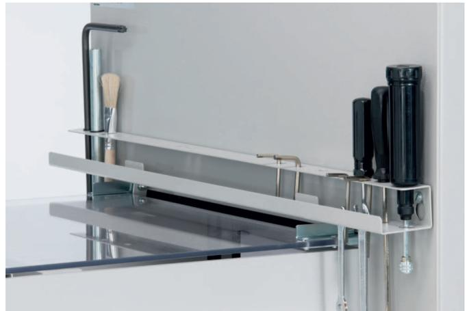
**ABNEHMBARER WERKZEUGHALTER** Für Messerwechsel und Servicearbeiten ist das benötigte Werkzeug immer griffbereit an der Maschine verfügbar.
